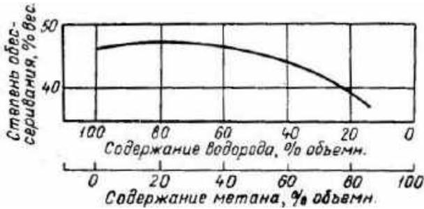
**Рис. 1.** Влияние концентрации водорода на степень обессеривания прямогонного дистиллята ( $T = 350\text{ }^{\circ}\text{C}$ , объемная скорость подачи сырья  $4,0\text{ час}^{-1}$ , парциальное давление водорода около  $10\text{ ат.}$ )
