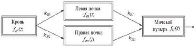
**Рис. 1.** Схема модели кинетики Тс-99м-пентатеха при динамической сцинтиграфии почек
