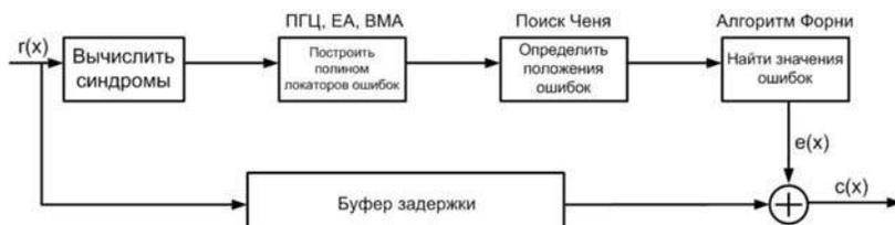
Рис. 2. Блок-схема декодирования БЧХ
