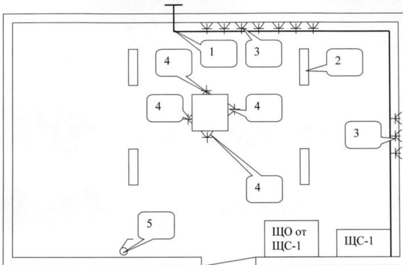
1. Контур заземления.
