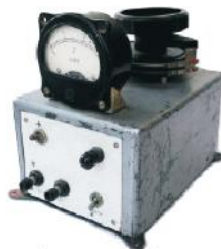
Полярोगраф – прибор для измерения предельного тока или напряжения, величина которого зависит от концентрации анализируемого вещества. 1970-е гг.
